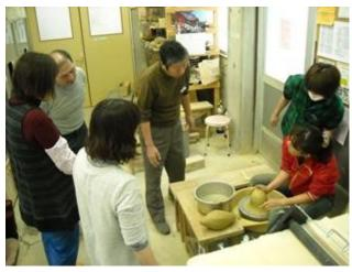
練った土をろくろの盤の真ん中にくっつけたら、しっかりとお水をつけて滑るようにし、両手で粘土を挟む様に力を加え上に伸ばしていきます。そして長く伸びたら、今度は粘土を縮めて最初の状態に戻します。
