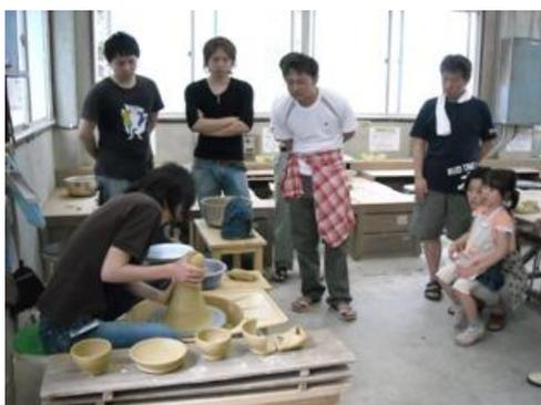
そしてろくろに粘土を据え付けたら、「土殺し」して、粘土をろくろの上で芯出しします。
